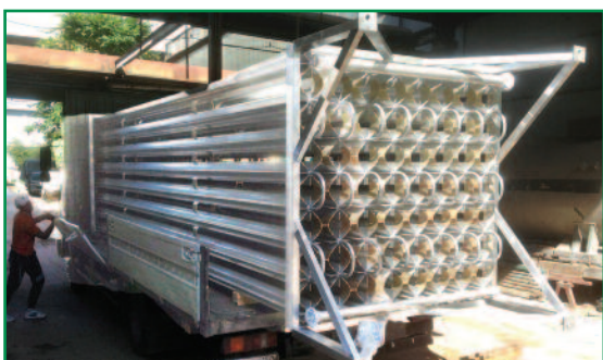
Фото 5. Погрузка испарителя ИС 1600-С для СПГ номинальной производительности 1300 \text{нм}^3/\text{ч} по метану
