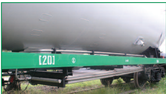
Фото 1. Испаритель подъёма давления ООО «НПО Мониторинг» в составе вагона-цистерны модели 15-558С-01 производства ОАО «Уралкриомаш» для перевозки и хранения жидких кислорода, азота, аргона
