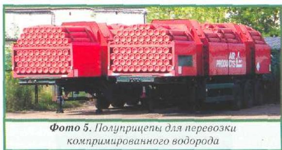
Фото 5. Полуприцепы для перевозки компримированного водорода
