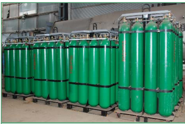
Фото 2. Моноблоки для водорода из 8-ми и 12-ти баллонов
