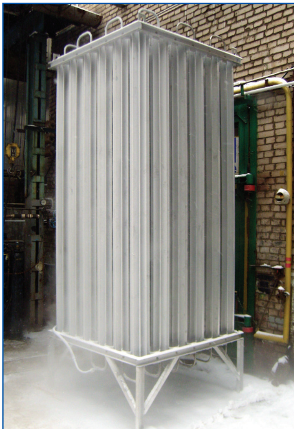
Фото 4. Испаритель ИВ-0350-С во время проведения натурных испытаний
