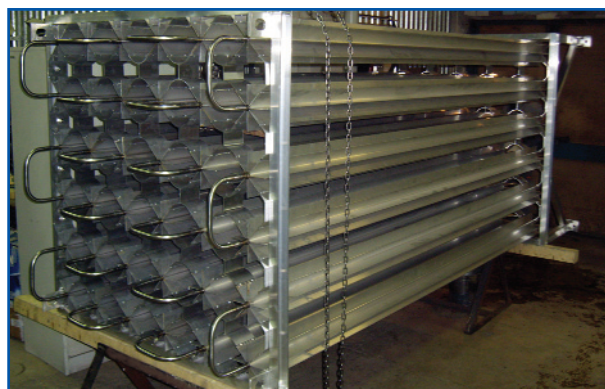
Фото 3. Гидравлическое испытание испарителя ИВ-0350-С
