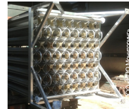
Погрузка испарителя ИС 1600-С для СПГ, номинальной производительностью 1300 нм 3 /час по метану
