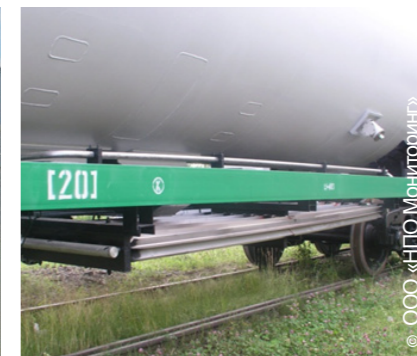
Испаритель подъема давления ООО «НПО Мониторинг» в составе вагона-цистерны модели 15-558С-01 производства ОАО «Уралкриомаш»
